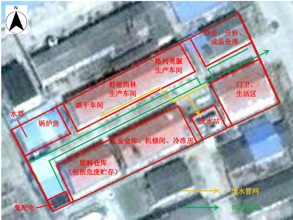
图 3.2-5 本地块平面布置及地下设施分布图
