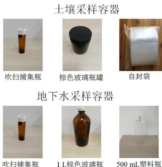
图5.3-3 土壤、地下水采样容器
