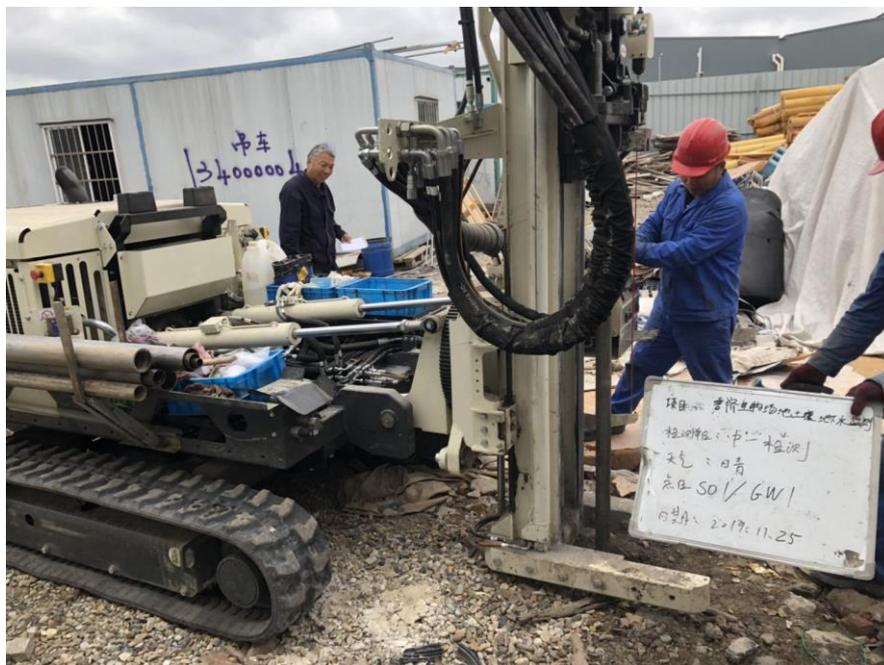
图 5.2-1 power probe 9410-VTR 履带式自推进钻探机
