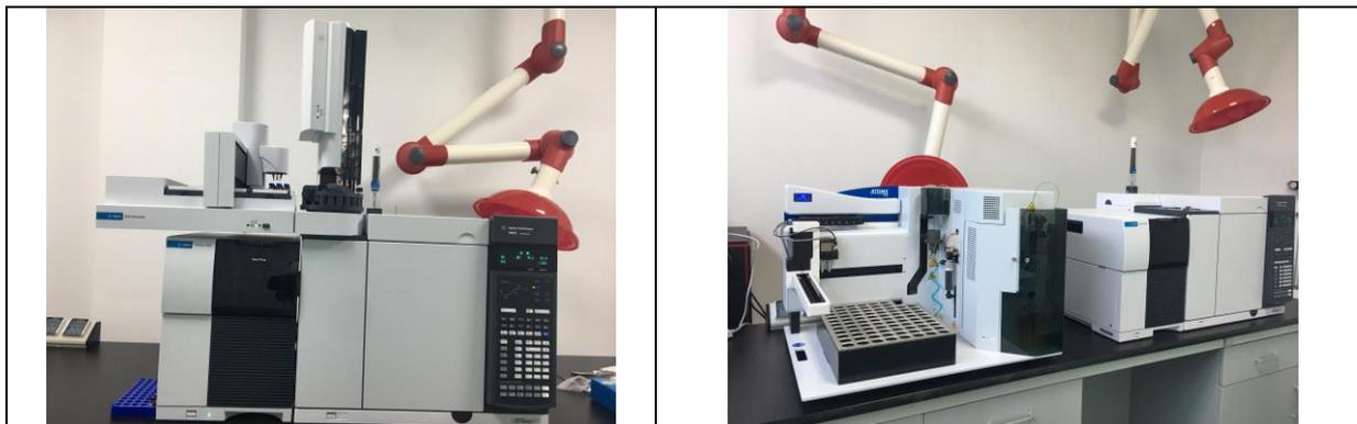
图5.5-2 气相色谱质谱联用仪及气相色谱仪
