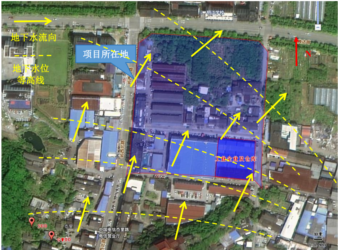
图 4.3-4 对照点点位及地下水流向示意图
