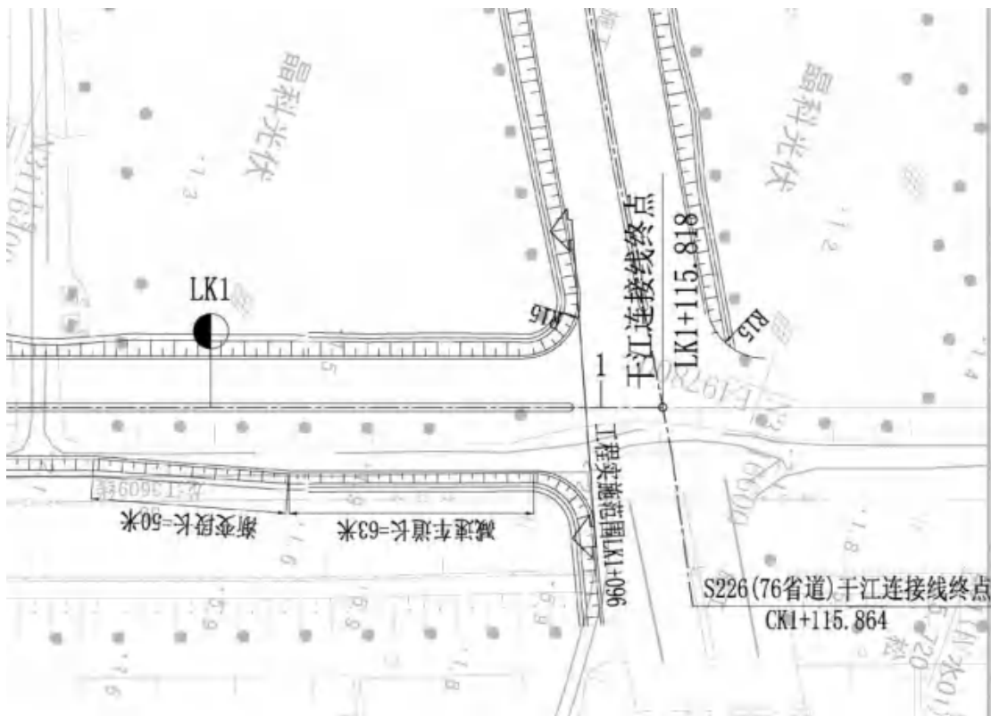
图 3.4-13 干江连接线与 S226 平面交叉布置图
