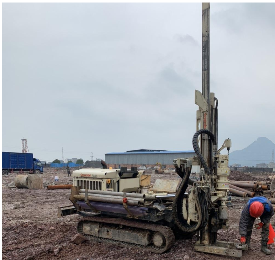
图 5.1-1 7822DT 履带式自推进钻探机
